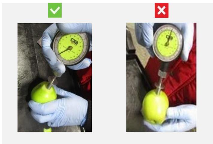
*La penetración debe realizarse apoyando el codo en una superficie plana, realizarlo a mano alzada modifica el resultado.*
