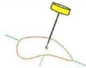
Productos con espesor menor al diámetro del vástago, longitud del sensor o que no se pueda penetrar (por ejemplo, cilantro, acelga)
