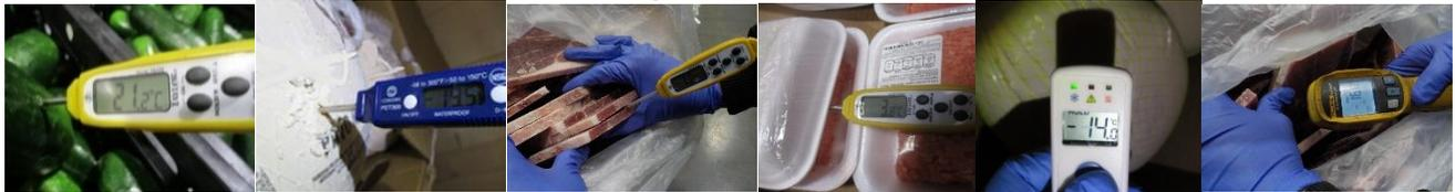
El resultado obtenido de la medición se compara contra la temperatura de especificación (**anexo 1**), encontrarse fuera de rango aceptado genera rechazo.
